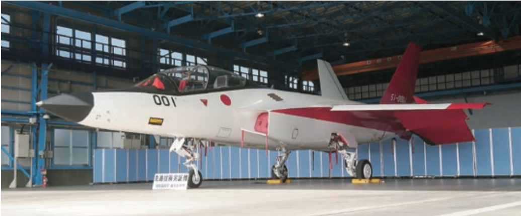
展示された先進技術実証機「X-2」。基本的耐空性、ステルス性、高速運動性の確認のために開発された国産機であり、日本の航空技術水準を高めるために大切な役割を果たす事が期待される。
