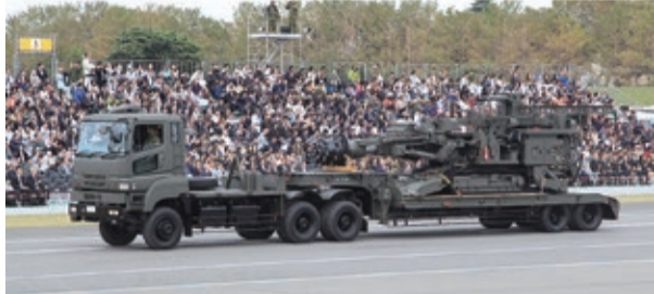
施設科の坑道掘削装置(ロードヘッダ)。陣地構築におけるトンネルの掘削に用いられる装備品である
