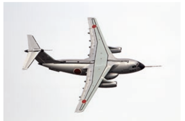
C-1の初号機を改造した試験機「C-1FTB」(フライト・テスト・ベッド)全面銀色の機体が眩しい。
