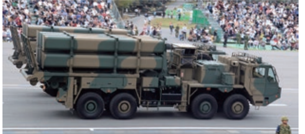
12式地对艦誘導弾(12SSM)。離島防衛の要となる装備品で、GPS誘導を追加し高精度化が図られている
