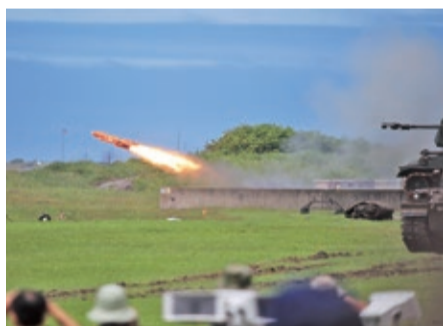
高速標的機CHUKA-III（チャカ3）の発射。曳航する標的が発するフレアを短SAMが狙う。富士重工宇都宮製作所で生産されたもの。
