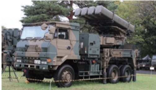
11式短距離地对空誘導弾。81短SAMの後継として制式化された装備で巡航ミサイルなどへの対処も可能となった。空自型は高機動車に搭載している
